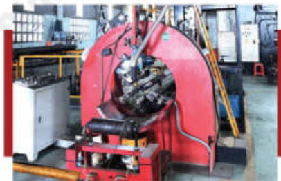
Máy hàn hồ quang Submerged arc welding machine
