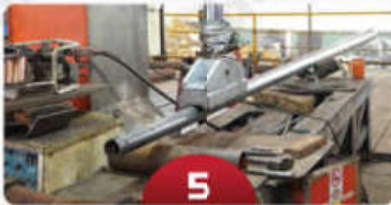
5 Quy trình nắn Light pole straighten process
