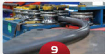
9 Uốn cần đèn Light pole top part bending process
