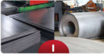
1 Chuẩn bị vật liệu: thép tấm, băng cuộn Prepare material: steel plate, tape rolls
