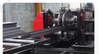
2 Đột lỗ, cán biên dạng và cắt hoặc Punching holes, rolling profile & cutting or
