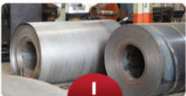
1 Chuẩn bị vật liệu: thép cuộn Prepare material: roll steel
