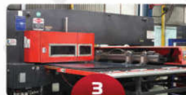
3 Quy trình đột Punching process
