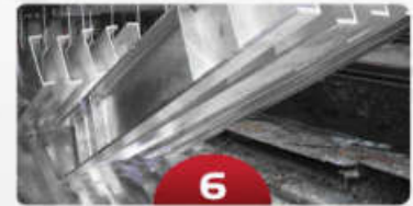
6 Mạ kẽm nhúng nóng Hot dip galvanizing process
