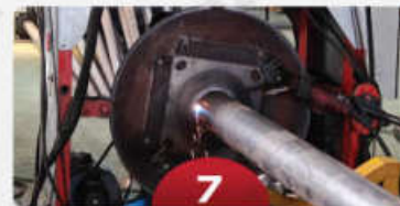
7 Hàn đế, hàn gông, hàn tai bắt phụ kiện Base plate, bracket and accessory lug welding
