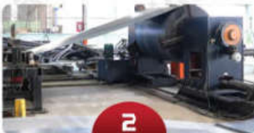
2 Quy trình cán, chặt, xả băng Rolling cutting - slitting process
