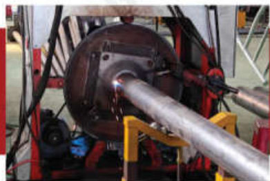
Máy hàn chân đế Light pole base welder
