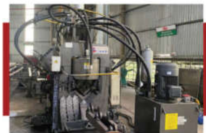
Máy đột chặt thép V Angle steel punching machine
