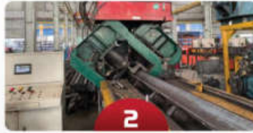
2 Đột cắt tự động CNC-V, CNC-U, I CNC-V CNC - U automatic punching & cutting process
