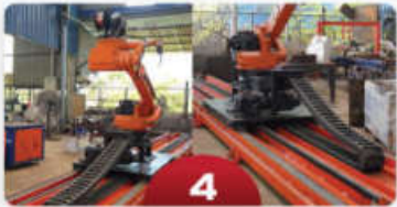
4 Hàn tự động Automatic welding process
