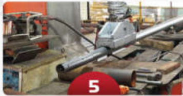
5 Quy trình nắn Straightening process
