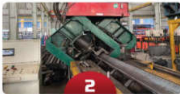
2 Đột cắt tự động CNC Punching - CNC automatic cutting
