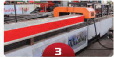
3 Quy trình hàn đà tự động Automatic welding process
