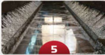
5 Mạ kẽm nhúng nóng Hot dip galvanizing process
