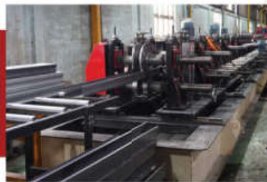
Máy cuốn thang máng cáp Roll forming machine
