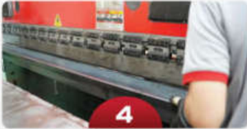
4 Quy trình chấn hoặc cán biên dạng Bending or rolling profiles process
